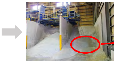
・固形燃料化システム 廃プラ、紙くず、木くず、繊維くずを混合して、 固形燃料を製造するリサイクルシステムです
