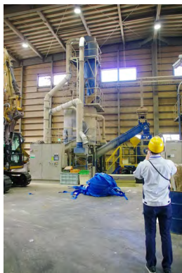
・固形燃料化システム 廃プラ、紙くず、木くず、繊維くずを混合して、 固形燃料を製造するリサイクルシステムです
