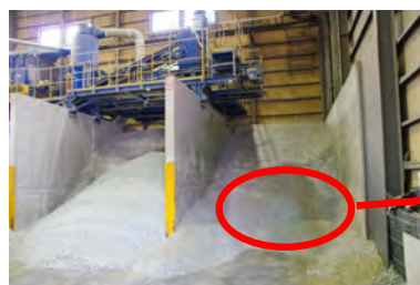
・固形燃料化システム 廃プラ、紙くず、木くず、繊維くずを混合して、 固形燃料を製造するリサイクルシステムです
